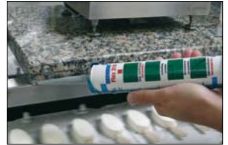
Flex 310 M – Incollaggio di una cornice di acciaio inox ad una piastra di granito
