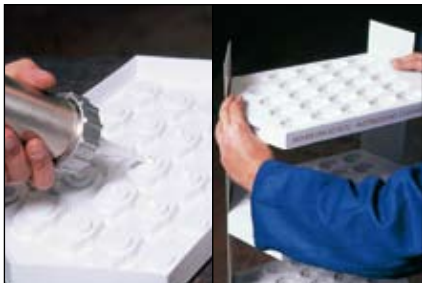
Flex 310 M – Incollaggio di espositori di vendita (poliestere/metallo)
