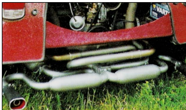
Ricondizionamento tubi scarico Auto d'epoca
