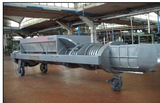
Cirio De Rica SpA Ricondizionamento impianto trita pomodori
